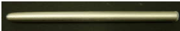
【キャップ接合後のチューブ外観】
